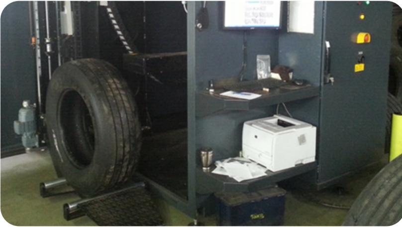
100 % der Karkassen gehen zusätzlich zur visuellen Kontrolle auf die Qualitätskontrolle mit Sherographie (Laserinterferometrie)
