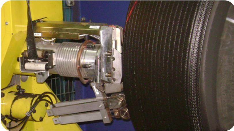
Der Polstergummi wird mit einer speziellen Roboterma­chine auf die Karkasse aufgetragen.
