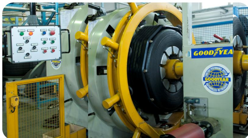
Von Goodyear lizenzierte Maschine für Ringprofil einlagen auf die Karkasse.
